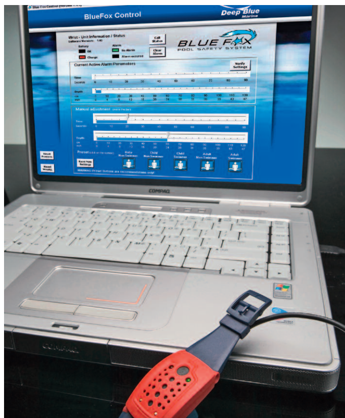
Ständige Kontrolle: BlueFox-Armbänder melden den gemessenen Druck über Funk an Sensoren in der Beckenwand und ermöglichen so eine elektronische Überwachung.
